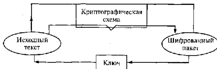
Рис. 6.5. Схема процесса дешифрования
