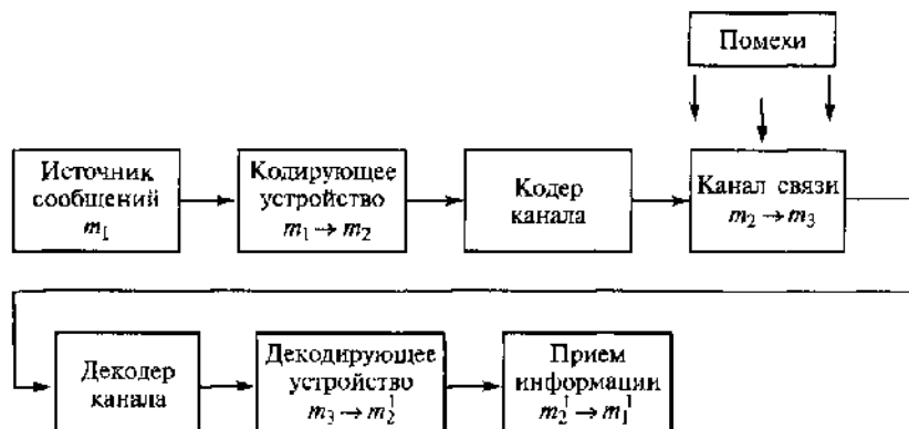
Рис. 6.7. Обобщенная схема передачи данных
